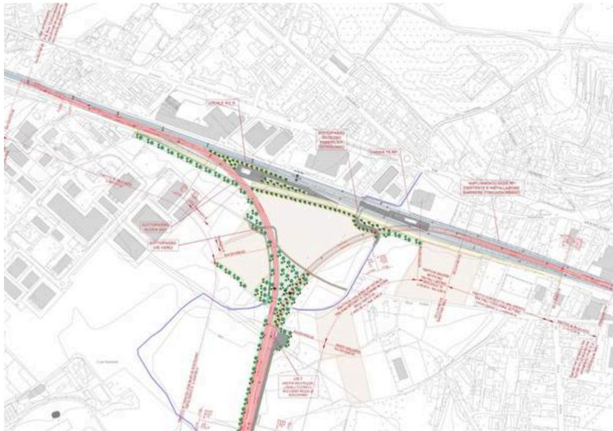
Il progetto della linea prevede anche **un allacciamento** (nella foto sopra) **alla linea del Sempione direzione Nord, verso Domodossola**. È un allacciamento che – per caratteristiche tecniche – non è adatto al passaggio di treni frequenti ed è stato pensato per ipotetici collegamenti verso la Svizzera tedesca e il Vallese.
