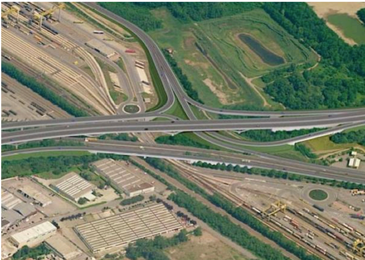
Il sistema di viadotti che supererà la ferrovia, lo scalo intermodale e la esistente superstrada 336
